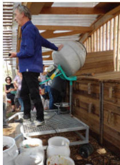
Bétonneuse à biodéchets, installée sur un chariot roulant pour faciliter le déplacement entre les composteurs. Composterre
